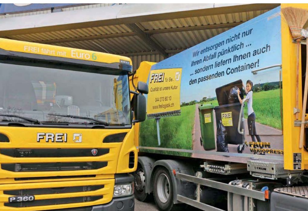
Der auffällig beschriftete Scania P360 LB 6x2*4 verfügt über einen besonders dichten Curved-Body-Variopress-Aufbau, der sich besonders fürs Sammeln von Grüngut eignet.
